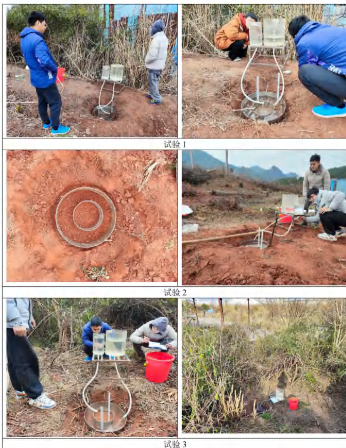
图 4.3.3.3-2 渗水试验现场
