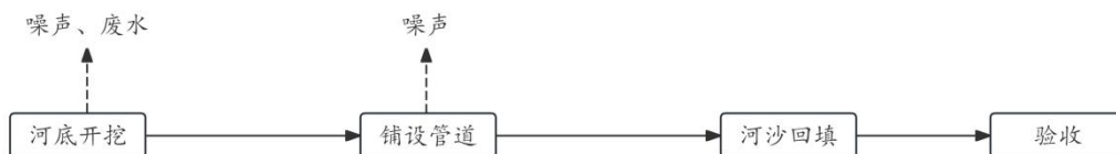
图 3.1-3 穿越河流施工工艺流程及产污环节图
