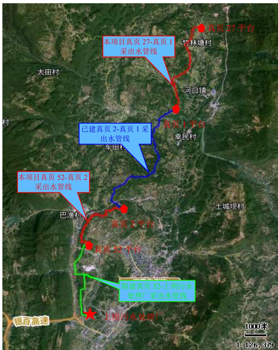
图 2.3-4 采出水管网衔接示意图
