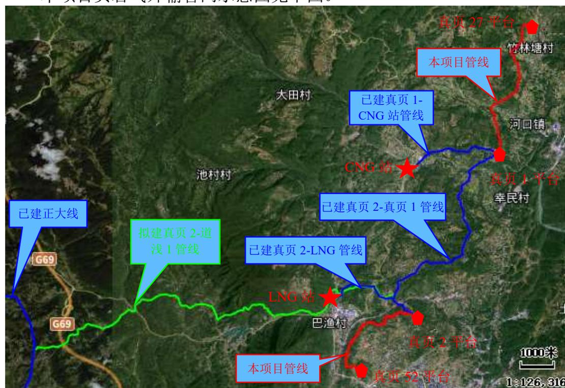
图 2.3-5 输气管网衔接示意图
