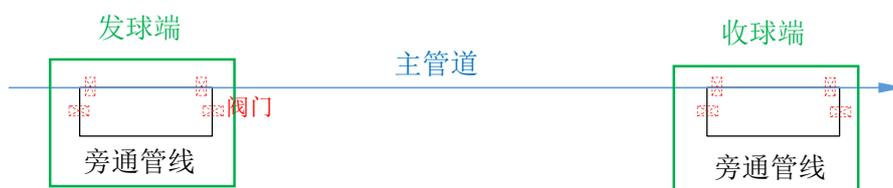
图 2.4-6 管线清管示意图
