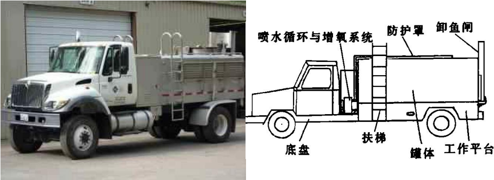
图 6.2-8 运鱼车外观及结构示意图
