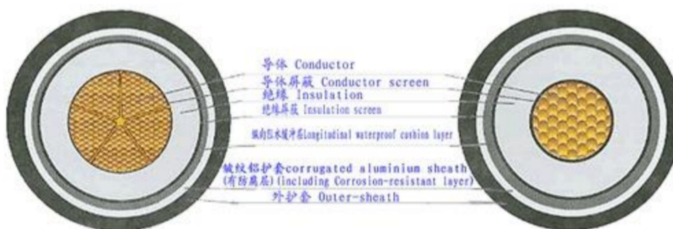
图 2-1 本工程电缆结构示意图
