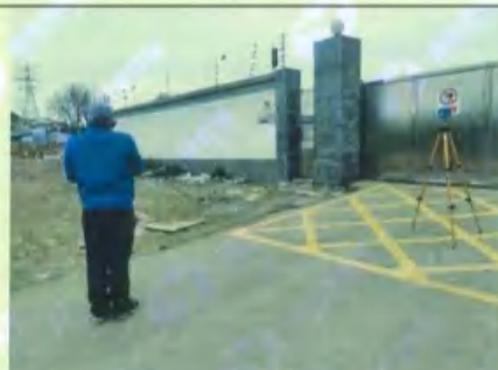
变电站北侧电磁监测
