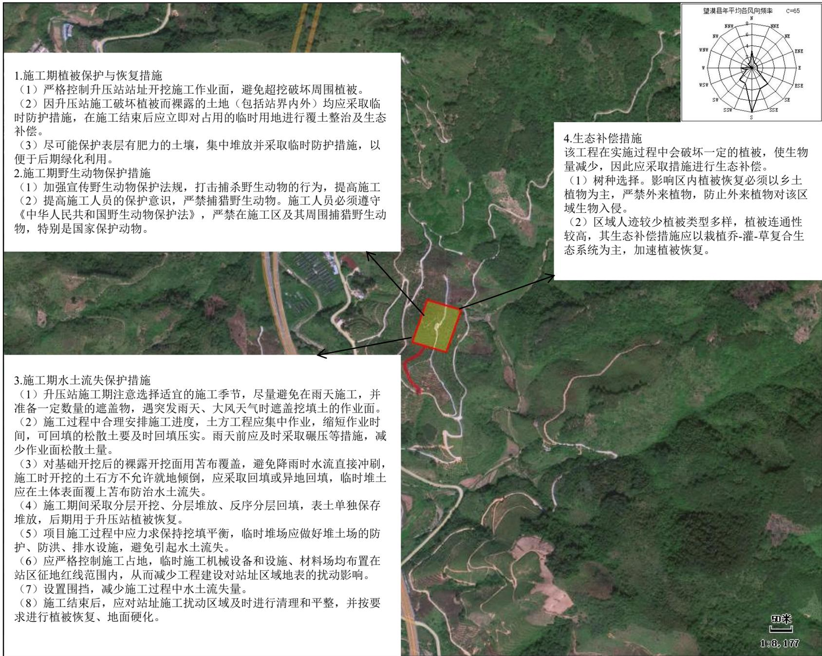
附图14 本工程施工期生态保护措施示意图
