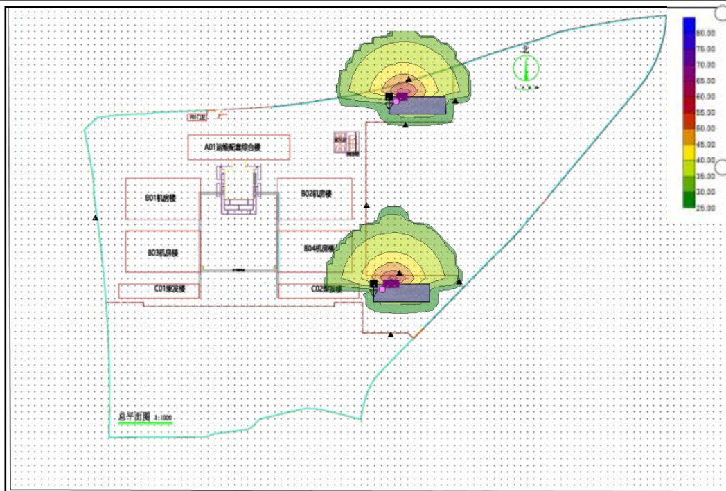
图 4-3 本项目变电站噪声等值线分布图
