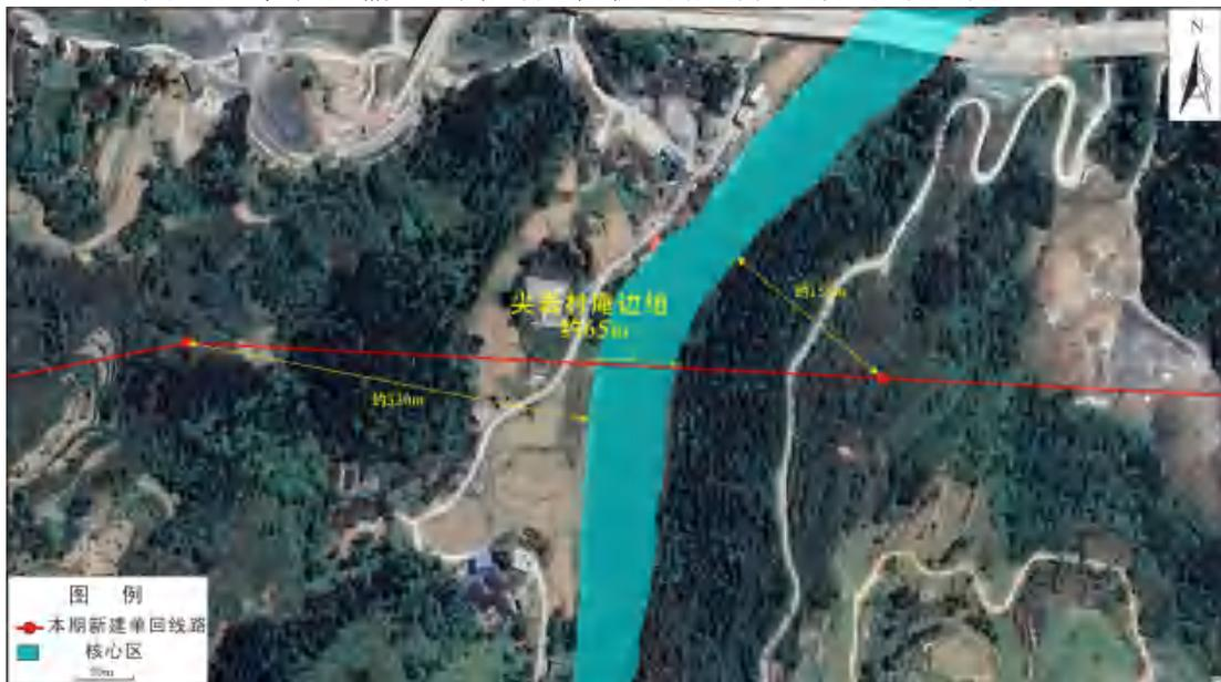
图 3-8 本项目输电线路跨越松桃河相对位置关系示意图 (2)
