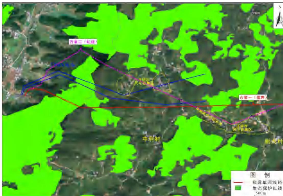
图4-7 本项目新建输电线路路径方案对比及制约因素情况
