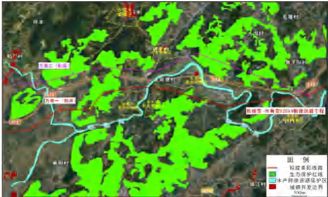
图4-8 本项目新建输电线路路径方案对比及制约因素情况
