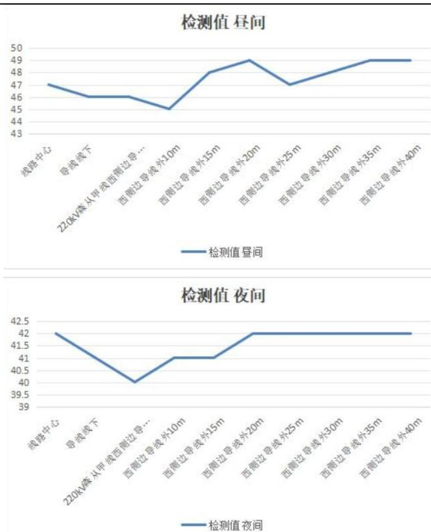
图 4.2 噪声监测断面衰减趋势示意图
