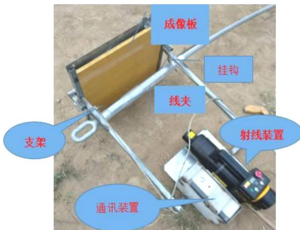
图9-3 本项目典型工件检测设备固定实景图
