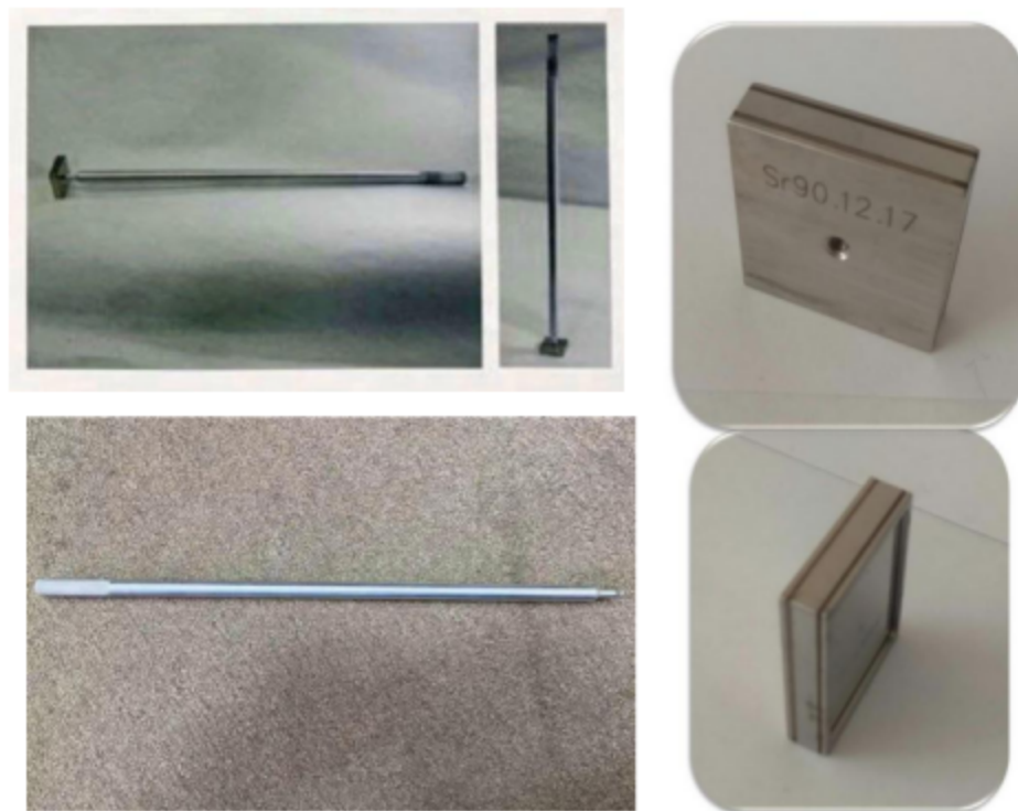
图 9-4 ^{90}\text{Sr} 治疗源及长手柄实物示意图
