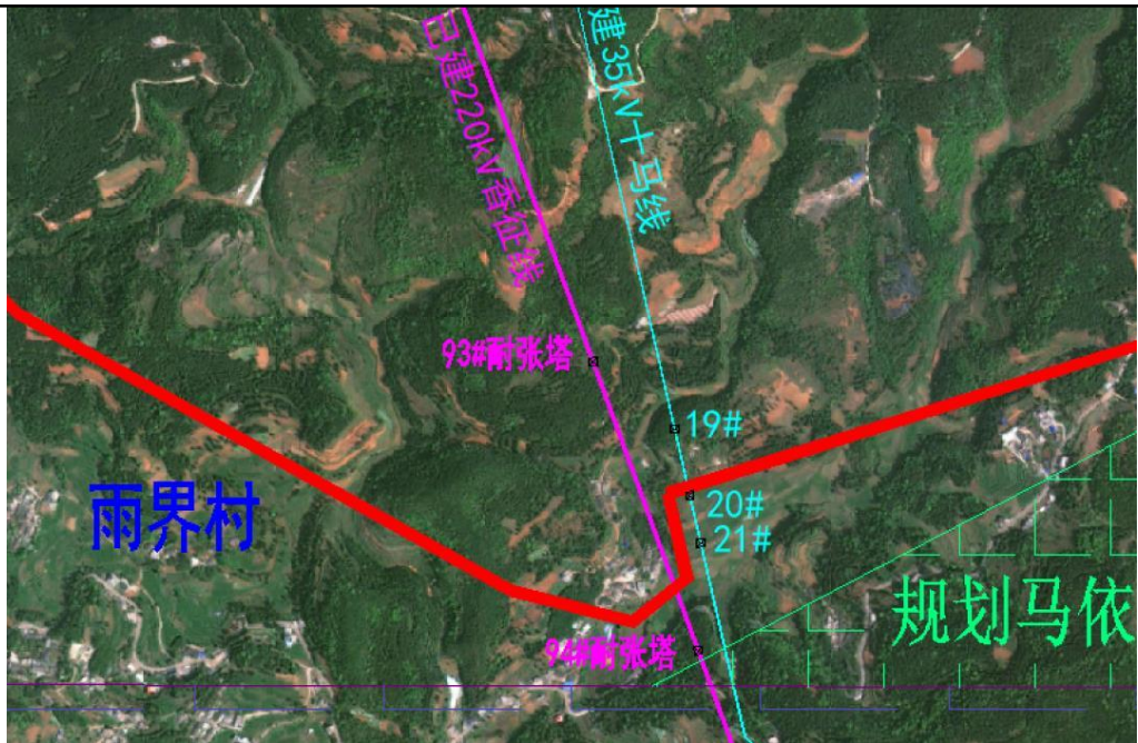
图 2-7 穿越已建 220kV 香征线（093#-094#档）平面示意图
