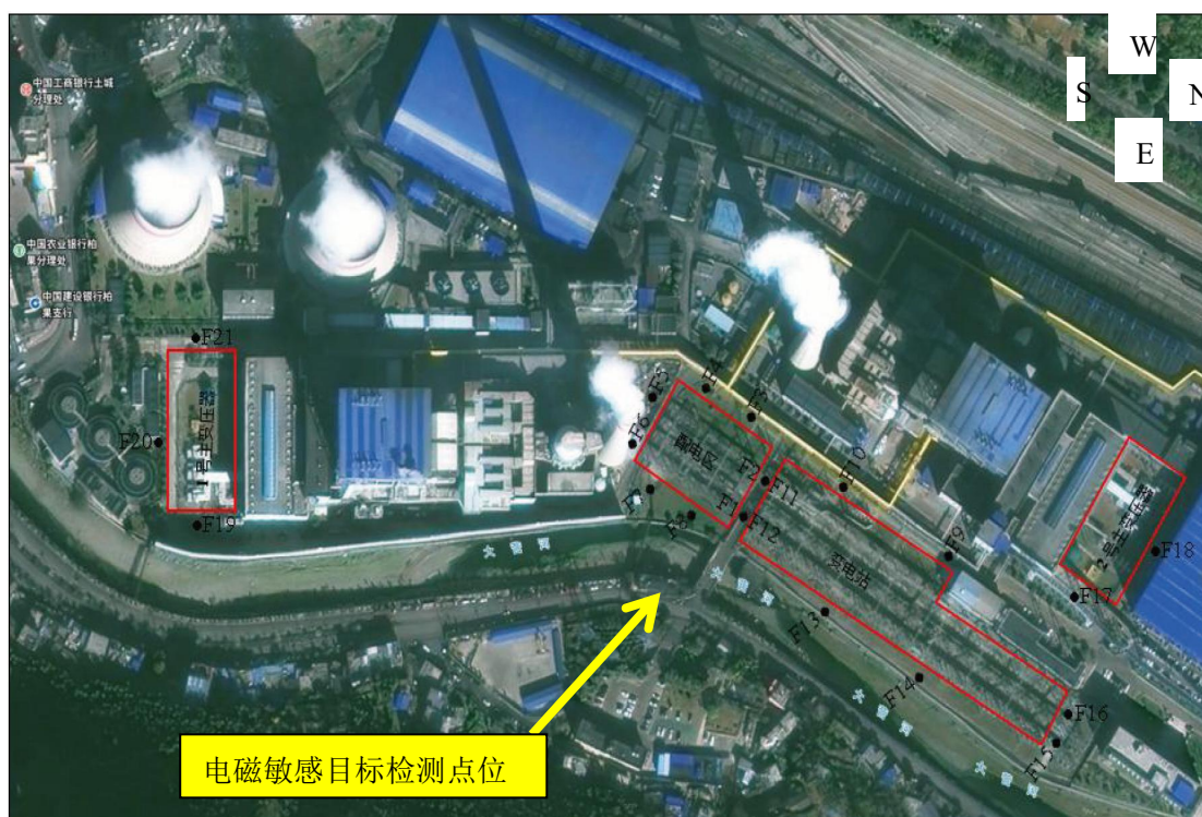
图 5.6-1 变电站站址周边监测布点示意图
