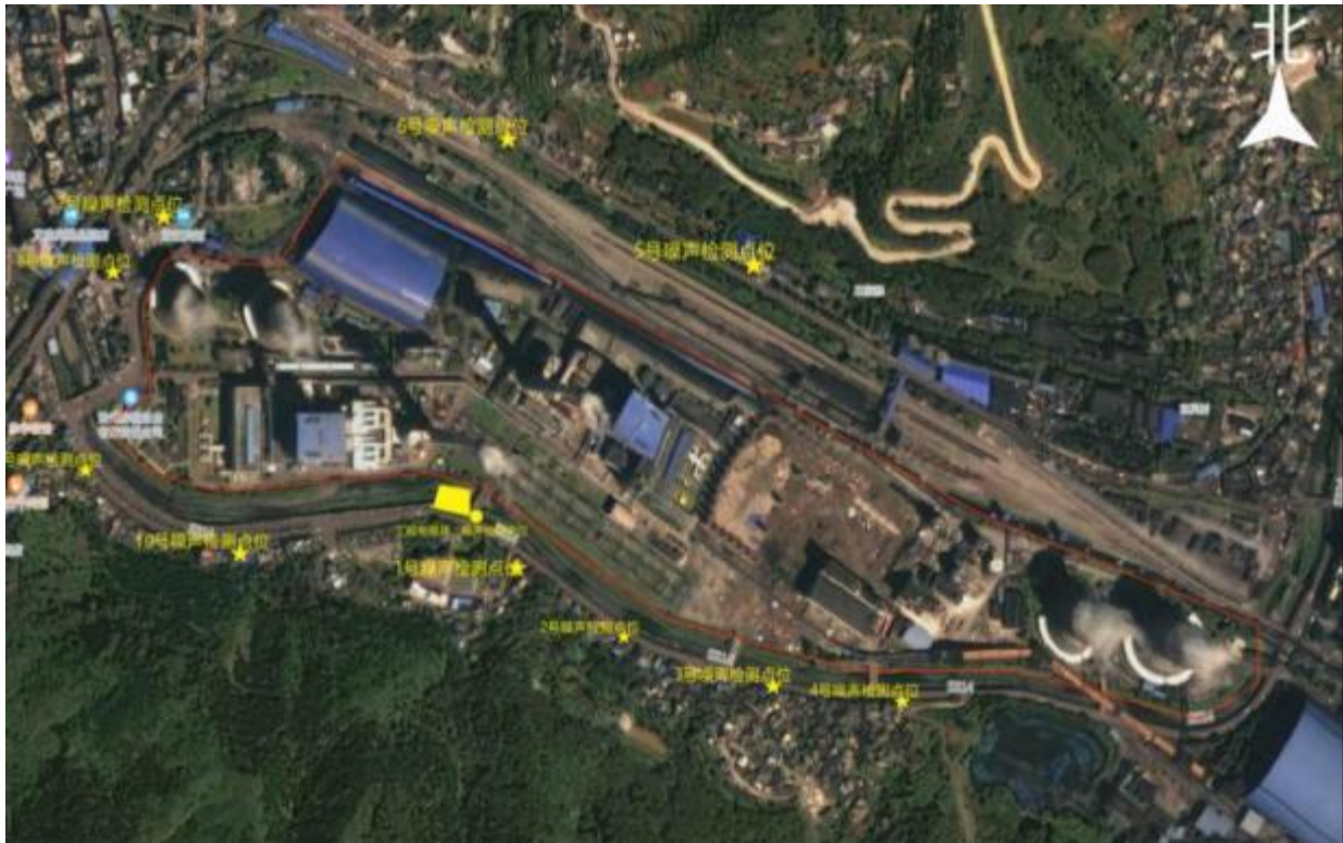
图 3-2 盘县电厂敏感目标噪声监测布点图
