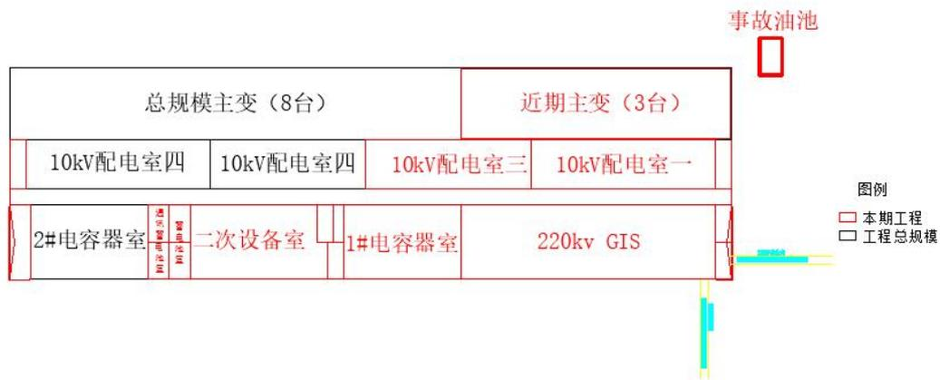
图 2-1 220kV 变电站总布置示意图
