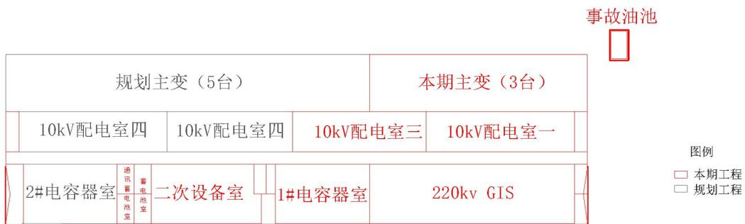
图 5-3 本工程 220kV 变电站平面布置图
