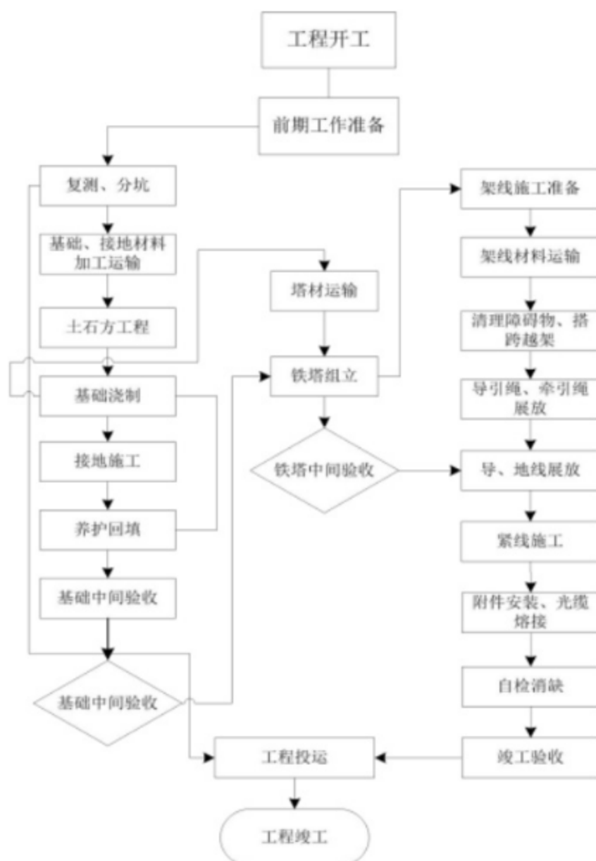
图 2.7-2 架空线路建设流程示意图
