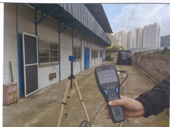
敏感目标电磁环境监测（二桥污水处理厂施工项目部）
