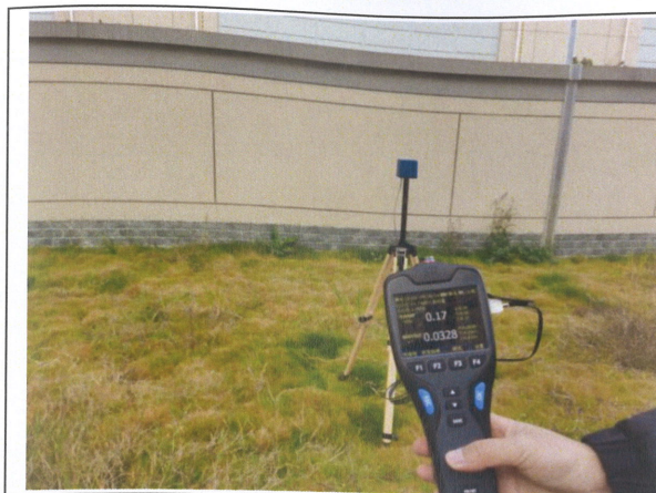
变电站东南侧电磁环境监测
