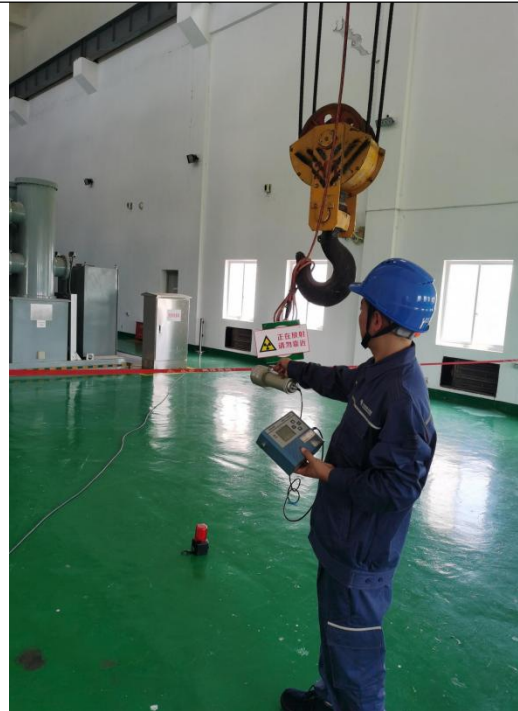
探伤机现场作业警戒带
