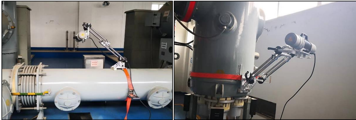
图 9-5 本项目探伤机固定方式
