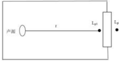
图 5.2-1 室内声源等效为室外声源图例
