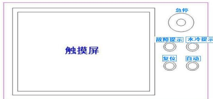
图 10-7 触摸屏操作箱面板图
