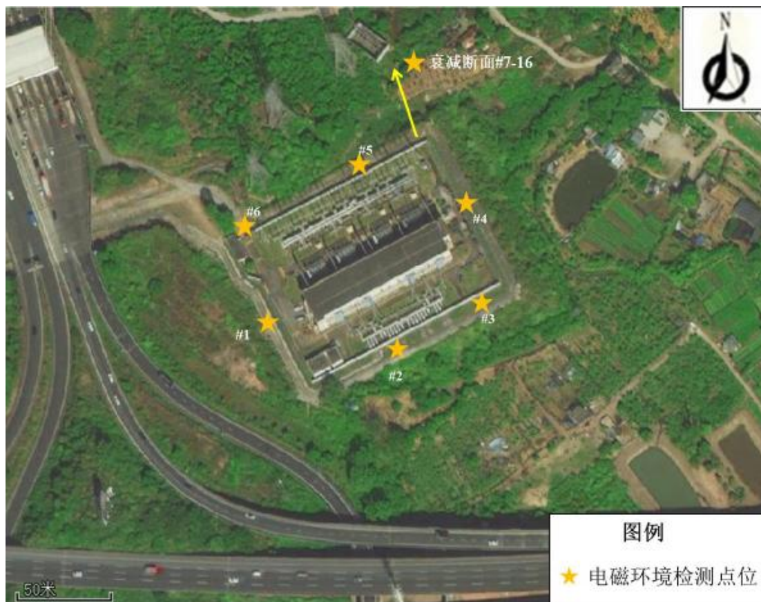
图 5-2 220kV 则徐变电站平面布置及监测布点图
