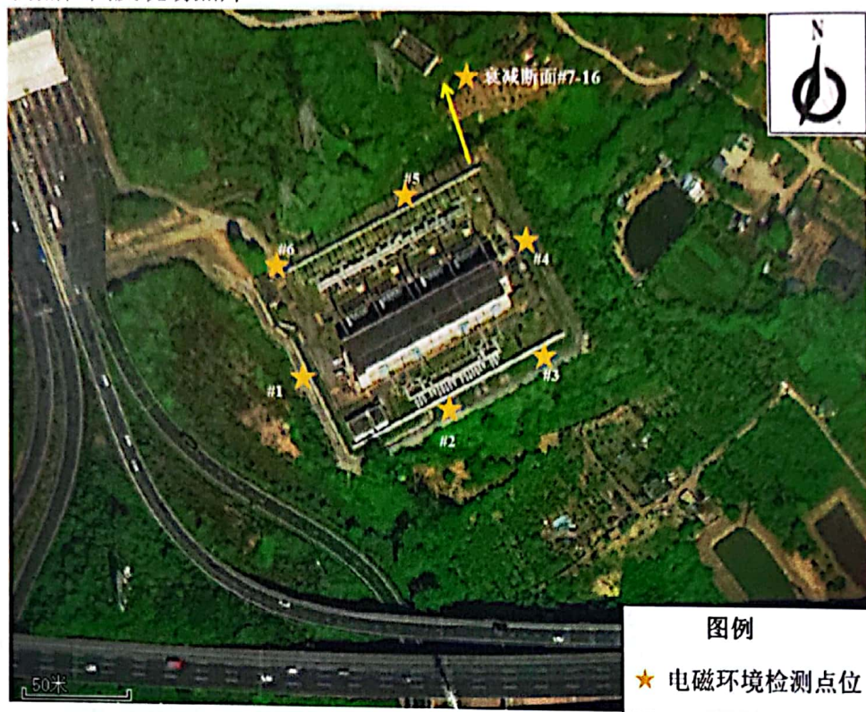
图 1 东莞市 220kV 则徐变电站电磁环境现状监测电磁环境检测布点示意图
