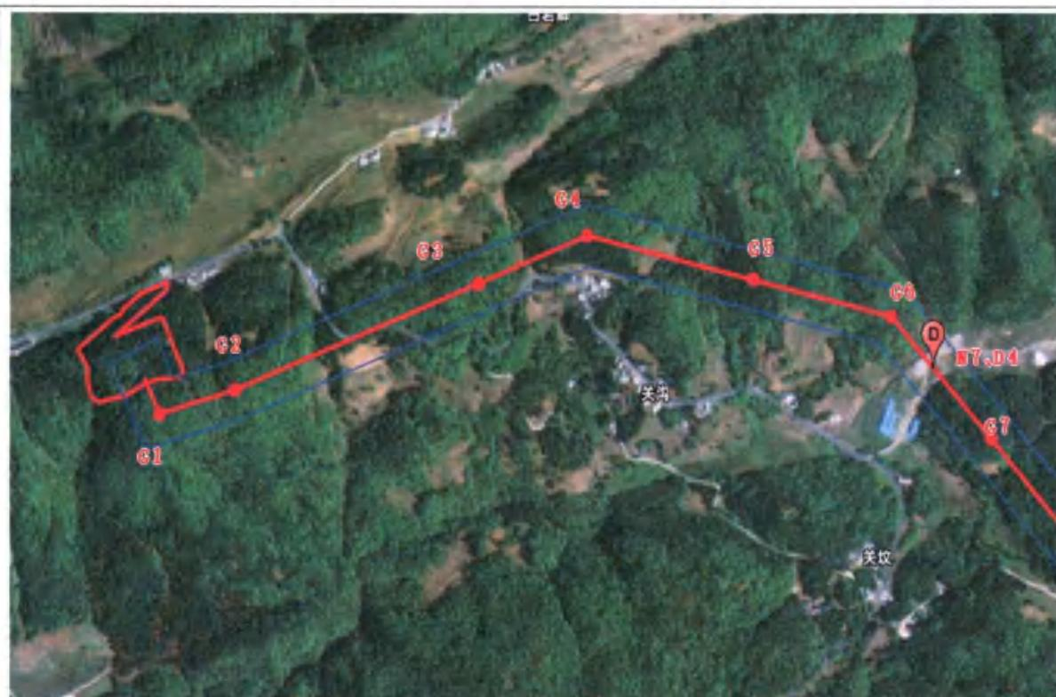
图 2 输电线路监测布点图
