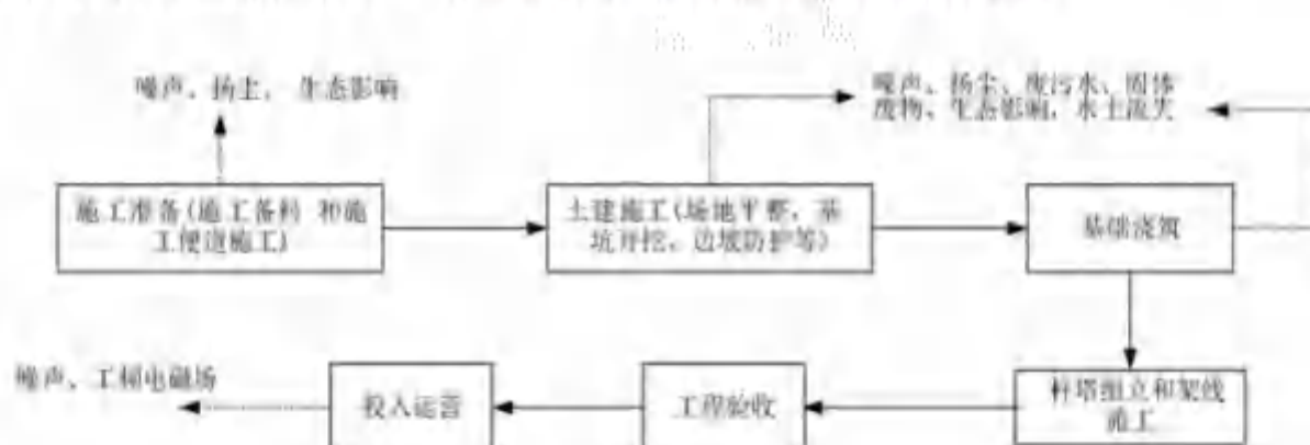
图 2.3-1 本工程污染工序流程图
