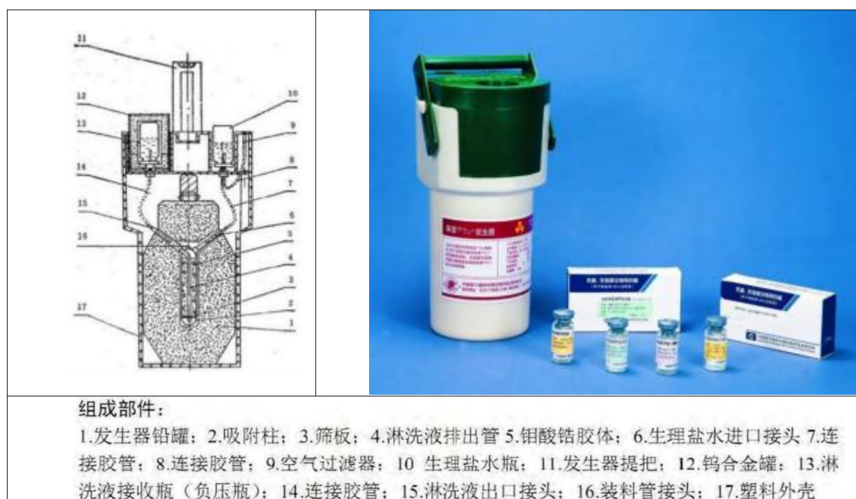
图 9-23 钼锝发生器的内部结构及实体图
