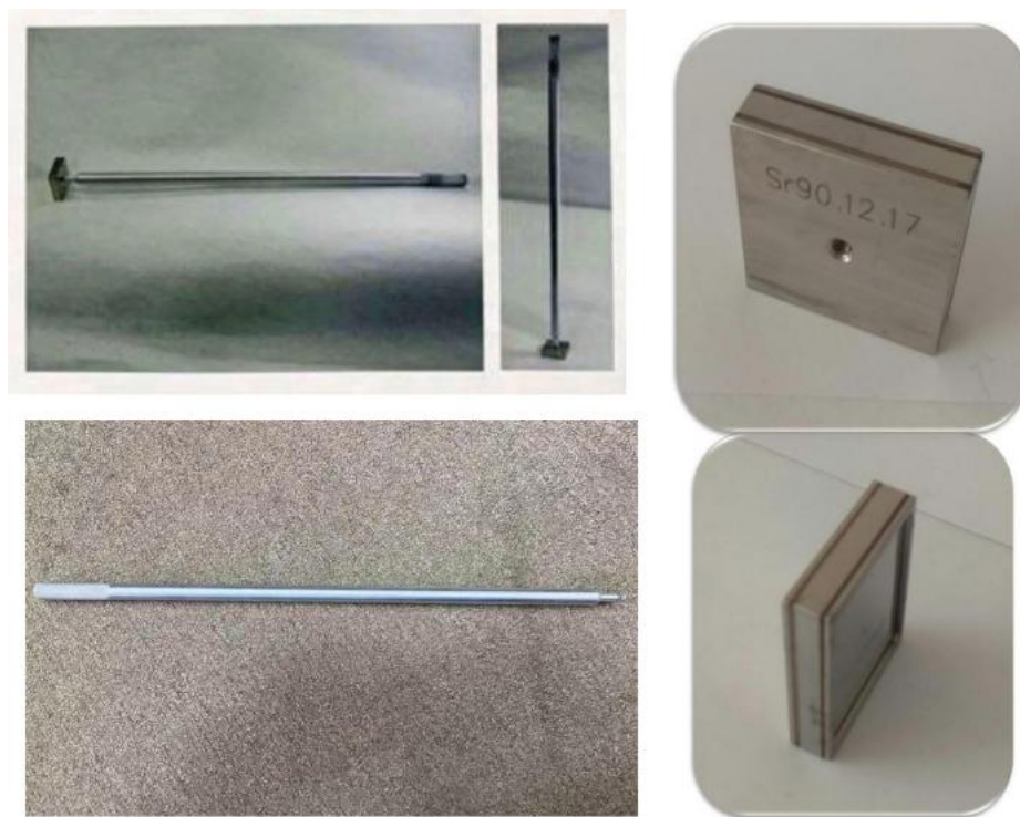
图 9-4 ^{90}\text{Sr} 治疗源及长手柄实物示意图
