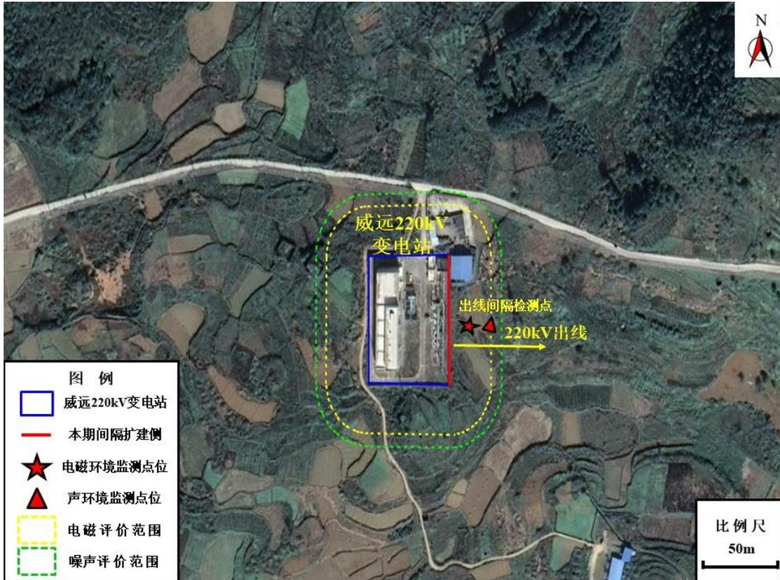
图 10 栗木 220kV 变电站间隔扩建侧电磁环境监测布点示意图
