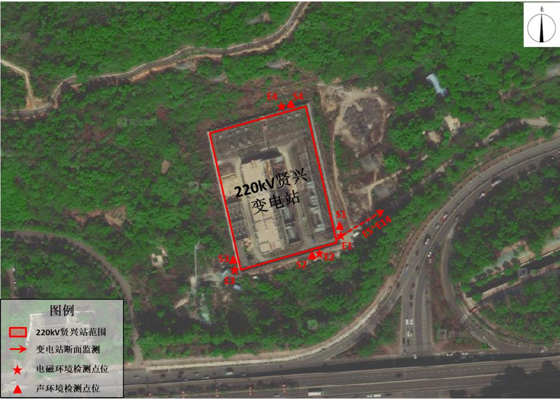
图I-8 类比对象深圳 220kV 贤兴变监测布点图
