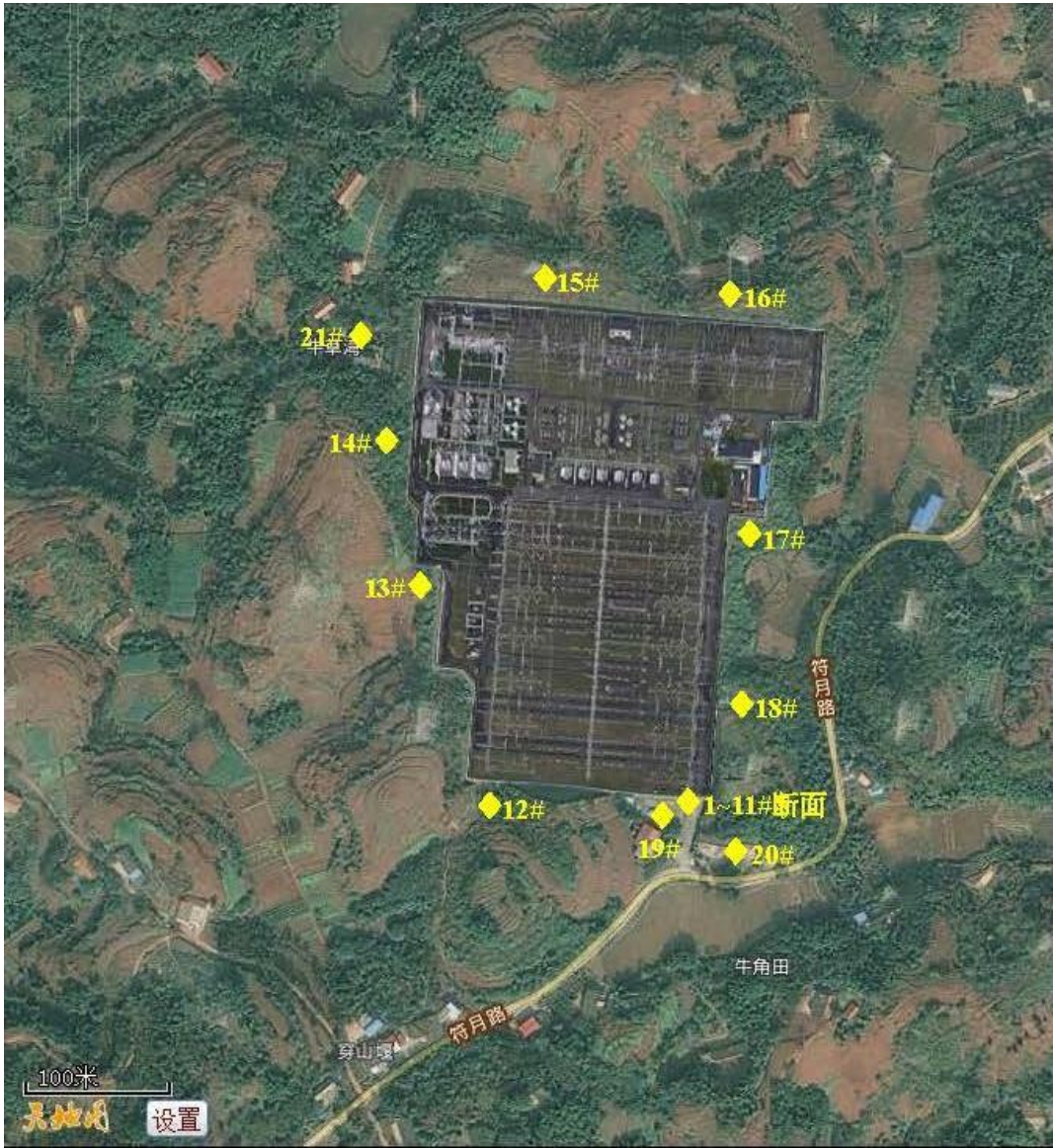
6.1-1 500kV 叙府变电站电磁环境类比监测示意图
