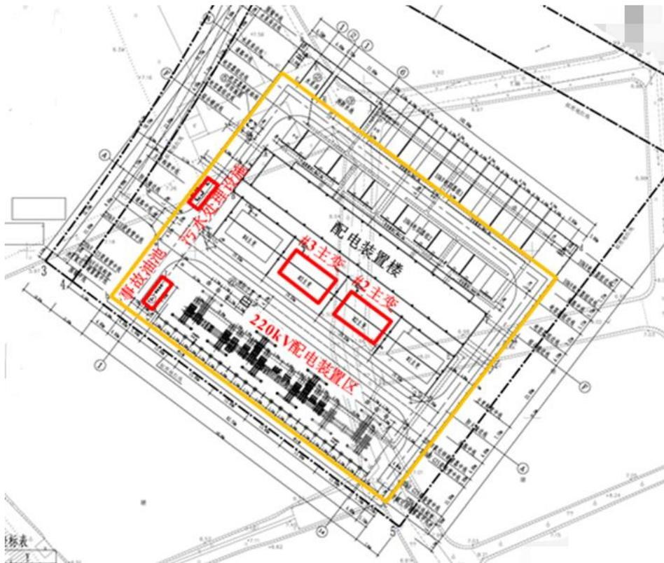
图 11 广州 220kV 车城变平面布置图
