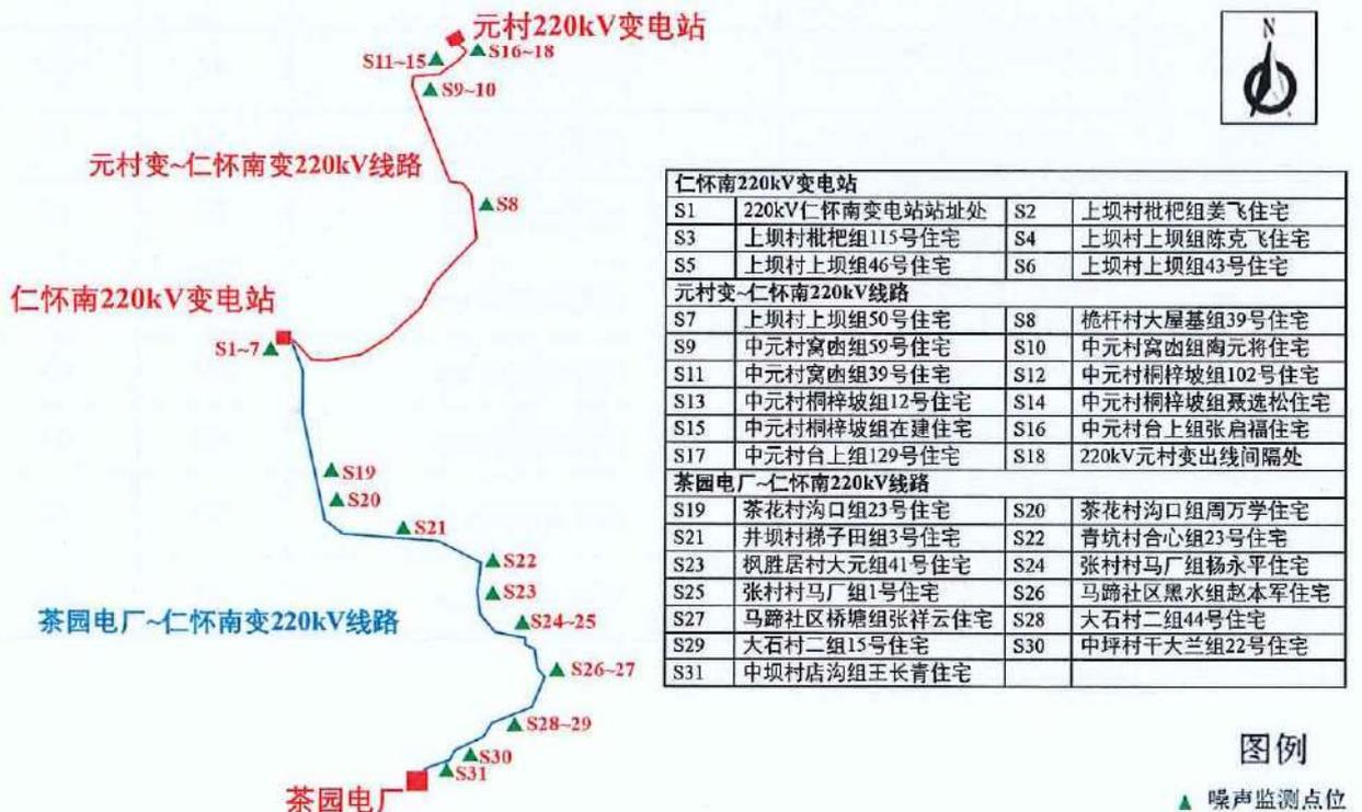
图 2 遵义仁怀南 220kV 输变电工程环评现状检测声环境检测点位
